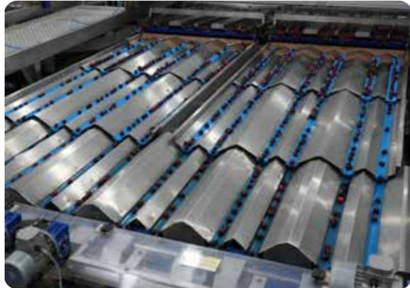
除此之外，车厘子采后技术也有显著提高。如今，智利车厘子预冷处理的效率比以往要快。车厘子主要由计算机控制的光谱分拣系统进行分拣，该系统甚至对果实内部缺陷也可以一览无余。这种分拣技术有助于确保供出口的车厘子的质量达到较高水平及一致性。
